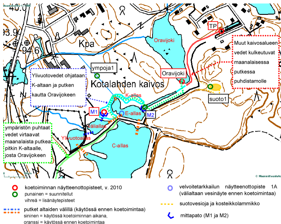
Kuva 18. Vesien järjestely ja mittapatojen paikat koetoiminnassa 2010 (kuva, Groundia Oy 2010 Koetoimintasuunnitelma.)
